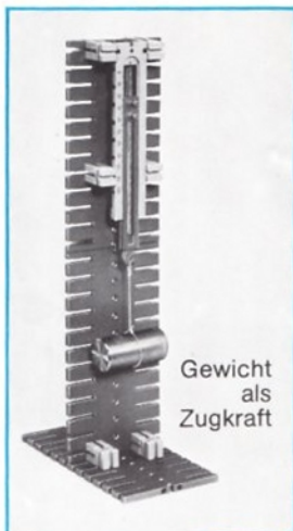
Kräfte-Messung an einem Flaschen-zug
