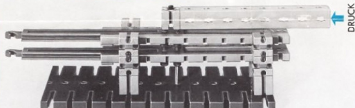
Zwei Kraftmesser kombiniert zu einem Druck-Kraftmesser
