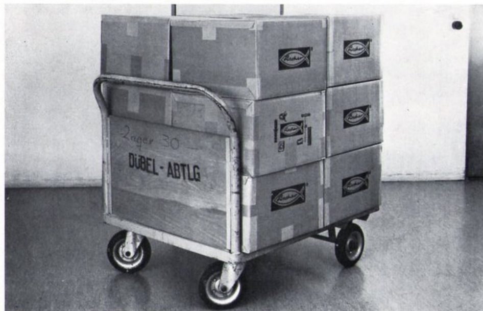
Abb. 7: Lager-Transportwagen mit 2 Schwenkrollen und zwei festen Rollen vorn.
