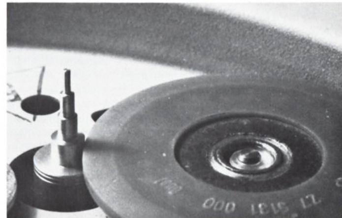
Abb. 2.7: Stufenwelle für Drehzahlumschaltung am Plattenspieler
