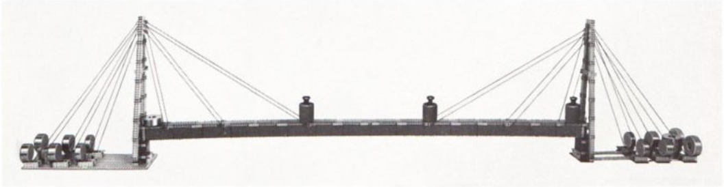
Abb. 34 Die Schrägseilbrücke mit gleicher Seilspannung wie in Abb. 33. Die 10 kp bewirken ein Absinken der vorher gekrümmten Fahrbahn.
