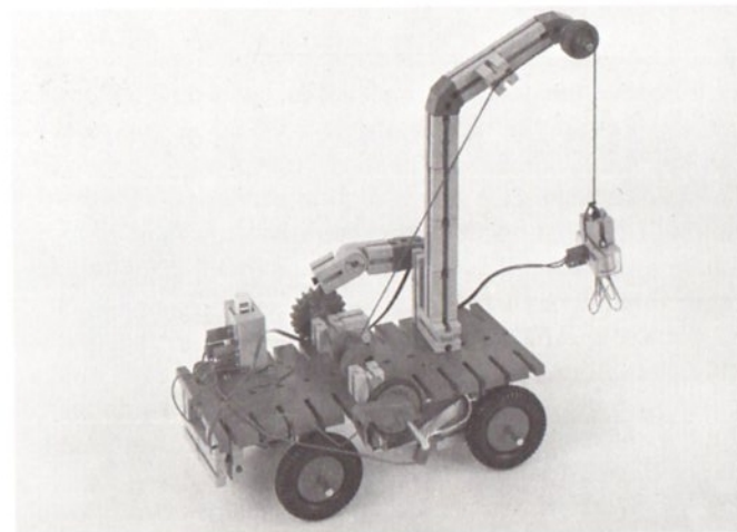
Abb. 13.4 Die angehobene Last wird durch die Sperre gehalten
