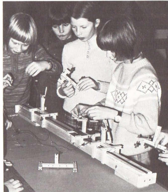
Abb. 15.9 Magnetschiene mit Schwebefahrzeugen
