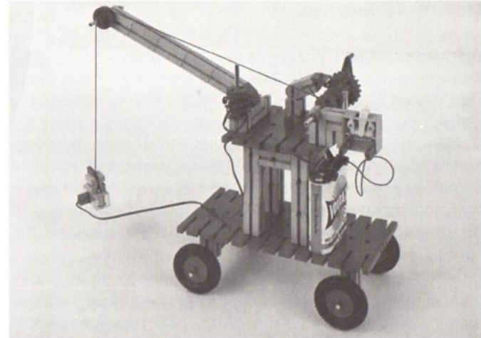
Abb. 13.5 Die obere Plattform kann geschwenkt werden
