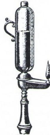
Eine brauchbare Uhr war auch das im Mittelalter häufig verwendete Stundenglas, bei dem der sinkende Spiegel des Lampenöls die Zeit anzeigte. An die Genauigkeit einer solchen Uhr durfte man allerdings keine allzu großen Ansprüche stellen, da auch die Dochtlänge eine Rolle spielte.
