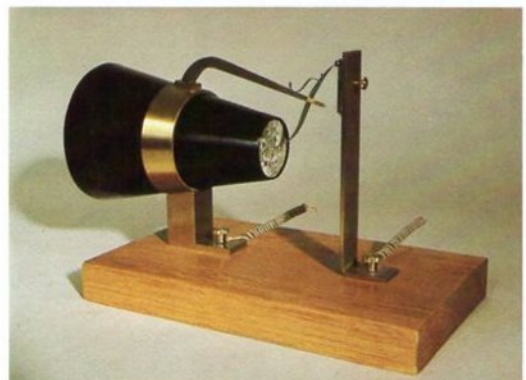
Das künstliche Ohr mit der Schweineblase als Trommelfell.
