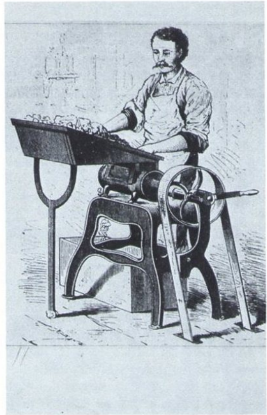
So wurde 1874 in New York Margarine hergestellt: Zunächst wurde der Fettrohstoff, Rindertalg, in einer Fetthackmaschine zerkleinert.
