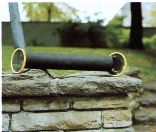
Das fertige Rohr mit den beiden Spiegeln (es ist ca. 1 Meter lang).
