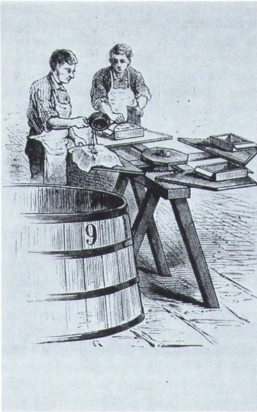
Das gefilterte und gereinigte flüssige Fett goß man anschließend in Formen und ließ es erkalten.
