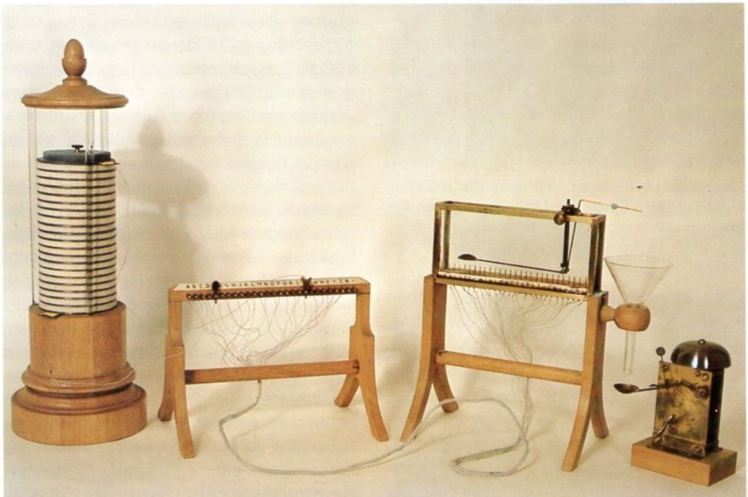
Der elektrolytische Telegraf von Sömmering (1809); zu sehen im Deutschen Museum, München, oder als Modell an der Technischen Hochschule Aachen.
