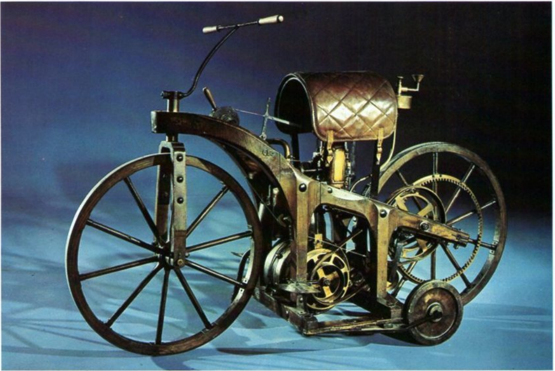
Das erste Motorrad der Welt baute Gottlieb Daimler. Sein „Petroleum Reitwagen“ aus dem Jahre 1885 wog 90 kg und hatte einen 260 ccm Einzylinder-Motor, der mit einer Leistung von nur einem halben PS eine Geschwindigkeit von 12 km/h erlaubte.
