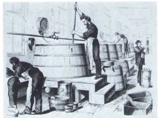
In großen hölzernen Bottichen, die mit Dampf beheizt wurden, schmolz man das reine Fett aus dem Talg und dem Fettgewebe.
