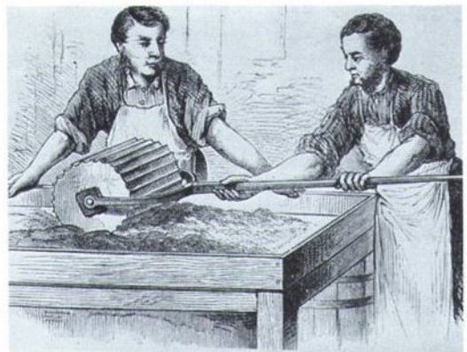
Zum Schluß wurde die Margarine noch einmal tüchtig durchgeknetet und anschließend in Fässer abgefüllt oder verpackt.
