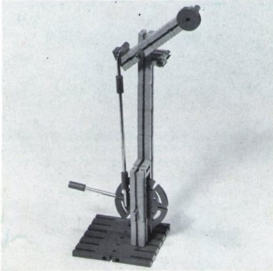
Abb. 3.9.8 Signal mit Stellrad. Die Bewegung des Hebels wird über das Stellrad (hier eine Drehscheibe) und über das Gestänge zum Signalfügel übertragen.
