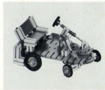
Abb. 7: Modell einer Seifenkiste mit Seilzugfußbremse und der für Seifenkistenrennen vorgeschriebenen Seilzuglenkung.
