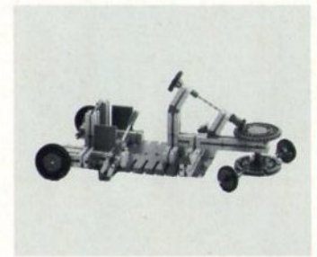
Abb. 8: Modell einer Seifenkiste mit tiefliegendem Schwerpunkt, Bodenschleifbremse und Übertragung der Lenkbewegung durch Zahnräder.
