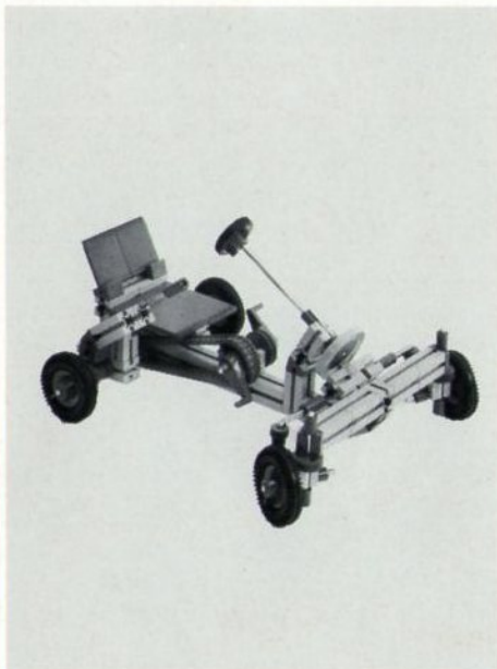
Abb. 9: Modell eines Kettcars mit Achsschenkellenkung mit zentralem Lenkhebel (hier Exzentrerscheibe) und Spurstange, sowie Kettenantrieb durch Tretkurbel.
