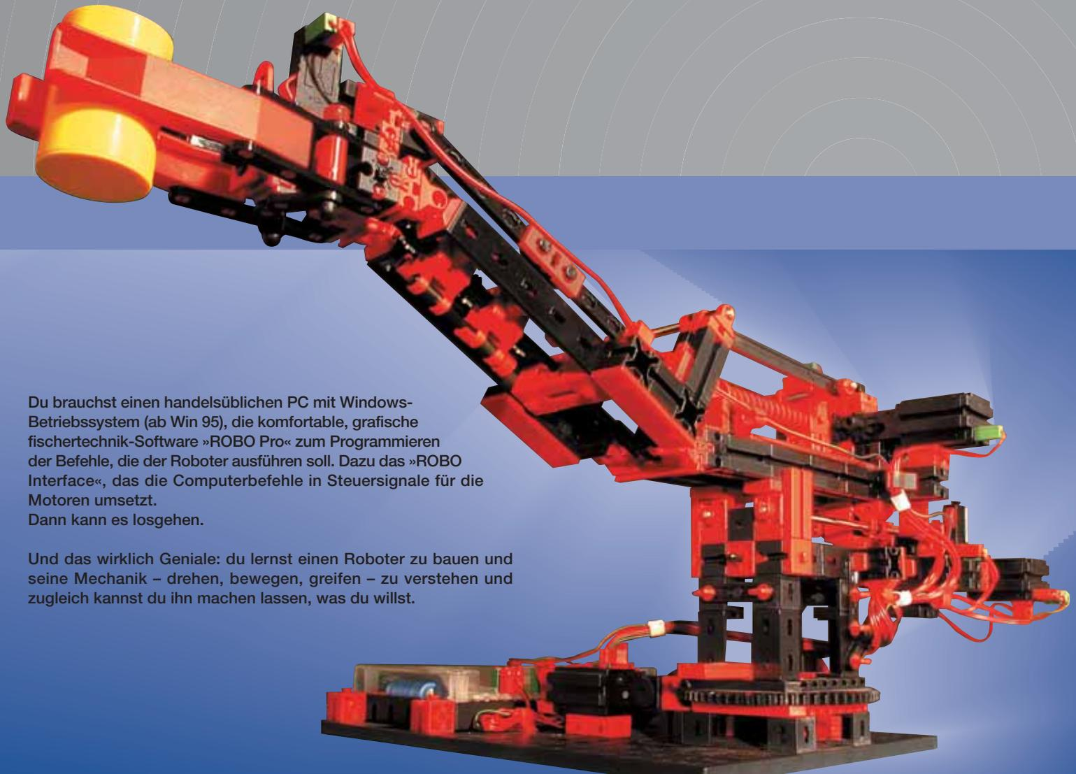
Du brauchst einen handelsüblichen PC mit Windows-Betriebssystem (ab Win 95), die komfortable, grafische fischertechnik-Software »ROBO Pro« zum Programmieren der Befehle, die der Roboter ausführen soll. Dazu das »ROBO Interface«, das die Computerbefehle in Steuersignale für die Motoren umsetzt. Dann kann es losgehen.
