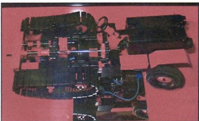
Foto 7: Rupsgedreven voertuig. Met de stuurinrichting worden de voorwielen bestuurd en de rupsbanden afgeremd.
