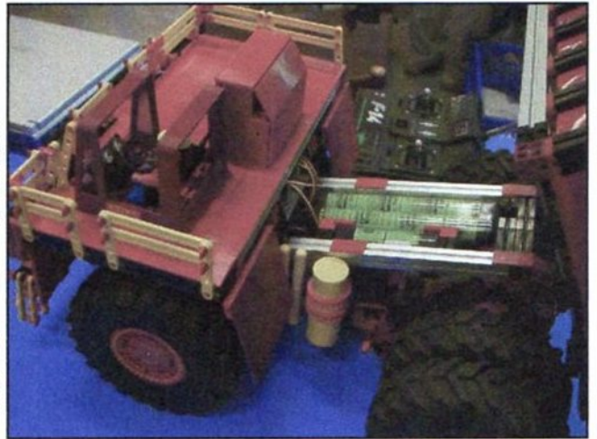
Foto 6: detail van de zandwagen met onder de laadbak een verzameling batterijen.
