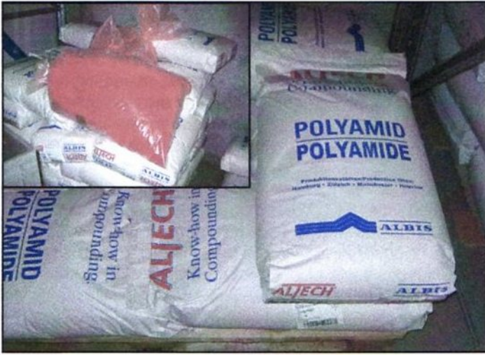
Basismateriaal voor Fischertechnik onderdelen. De inzet toont een zak met rode korrels.
