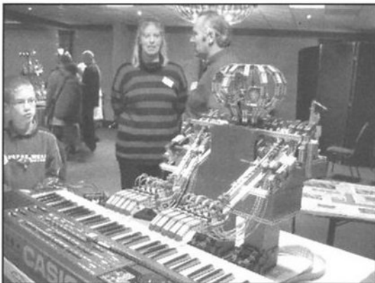
Links: 2x de keyboard spelende robot van Marcel Bosch. Boven de overzichtsfoto; onder een detail van de pneumatische aansturing.
