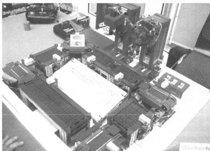
Rechts: Bewerkingsstraat van Wilhelm Brickwedde. Aangedreven door 20 motoren op 24 Volt en bestuurd met Simatic S5 SPS.
