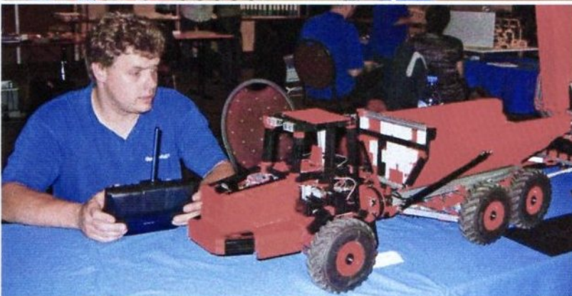
De knik-dumptruck van Anton Jansen had veel bekijks. Het model is voorzien van hydraulische cylinders waarmee de bak omhooggetild kan worden. Dat lukt zelfs als er een paar kilo zand in de bak zit (aldus Anton). Het model is verder volledig radiografisch gestuurd. Anton heeft in Veghel diverse rondjes met het model gereden.
