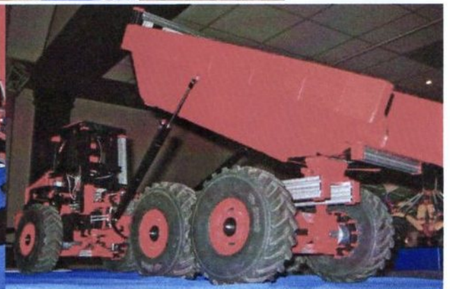
De knik-dumptruck van Anton Jansen had veel bekijks. Het model is voorzien van hydraulische cylinders waarmee de bak omhooggetild kan worden. Dat lukt zelfs als er een paar kilo zand in de bak zit (aldus Anton). Het model is verder volledig radiografisch gestuurd. Anton heeft in Veghel diverse rondjes met het model gereden.
