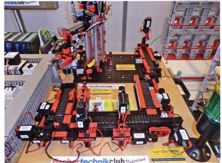
Deze foto toont een overzicht van het mobiele deel van het model. Hierin zitten robot 1 (midden boven) en de transportbanden 1 (links), 2 (onder), 3 (rechts) en 4 (rechts boven) en de componenten voor de boor en freesbewerking.
