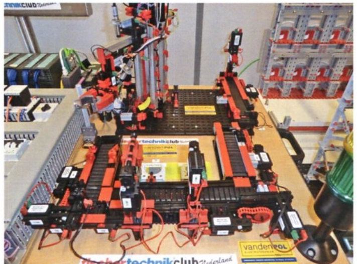
Dieses Foto zeigt eine Übersicht über den mobilen Teil des Modells. Hier sitzen Roboter 1 (mitte oben) und die Transport-Bänder 1 (links), 2 (unten), 3 (rechts) und 4 (rechts oben) und die Komponenten der Bohr- und Fräsbearbeitung
