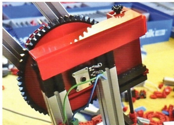
Foto 2: Das Potentiometer in der Modell-Anwendung
