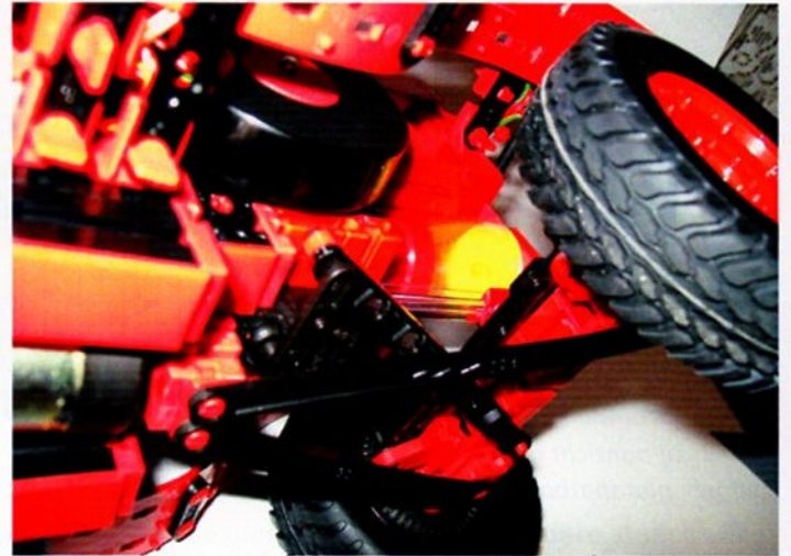
foto 8: De stuurstang wordt via de servo aangestuurd.
