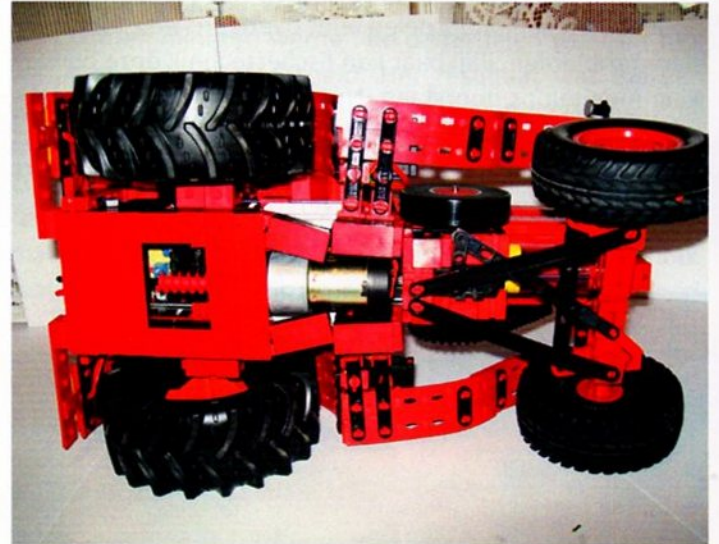
foto 9: Het model wordt met een Power motor direct op de achteras aangedreven. De vooras is een pendelas.
