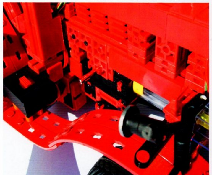
foto 2: De eencilinder motor (vliegwieltijdelijk verwijderd).
