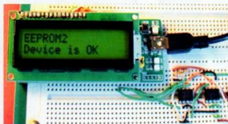
Figuur 1: Een testopstelling met I 2 C
