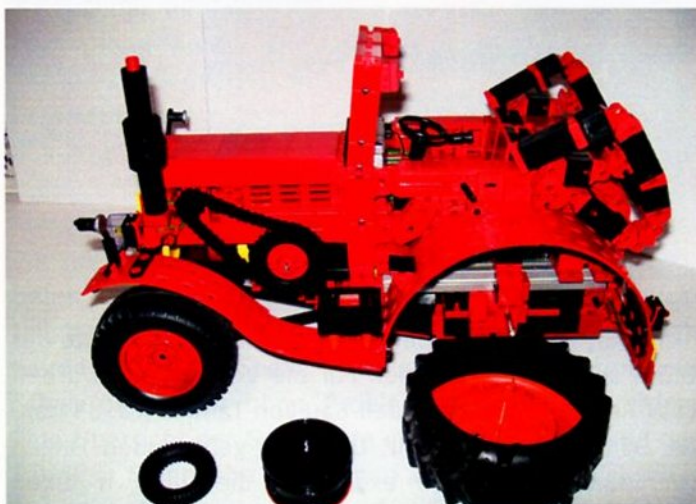
Foto 7: Antriebsriemen (vorne) und demontiertes Hinterrad.
