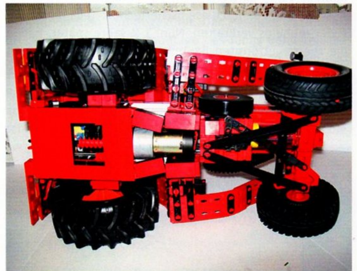
Foto 9: Das Modell wird von einem Power-Motor direkt über die Hinterachse angetrieben. Die Vorderachse ist eine Pendelachse.
