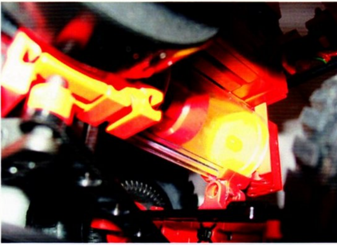
Foto 6: Der Antriebs-Zylinder mit bewegendem Kolben.
