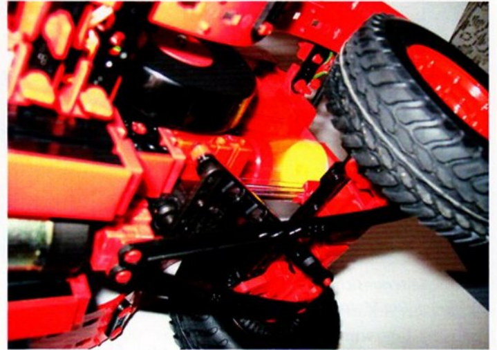
Foto 8: Die Lenkstange wird von einem Servo-Motor gesteuert.
