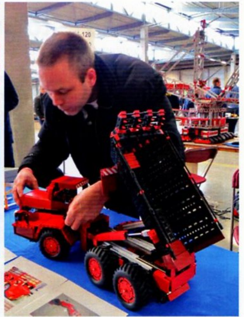
Ruurd Hessels: Bell B50D knikdumper (boven) en een Terex RH400 shovel (onder). De cilinders bij zo'n groot model zijn altijd een uitdaging vanwege het grote gewicht en Ruurd heeft dit fraai opgelost met draadijzer en moeren die vastzitten in een buis.
