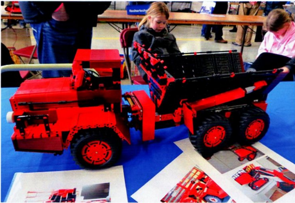
Ruurd Hessels: Bell B50D knikdumper (boven) en een Terex RH400 shovel (onder). De cilinders bij zo'n groot model zijn altijd een uitdaging vanwege het grote gewicht en Ruurd heeft dit fraai opgelost met draadijzer en moeren die vastzitten in een buis.
