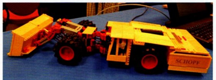
Peter Damen met een "Schoep" wiellader die -speciaal voor inzet ondergronds in de mijnbouw- heel laag is.
