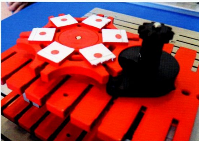
Rob van Oostenbrugge met een zeldzaam exemplaar van het Malteser kruis inclusief aandrijving.
