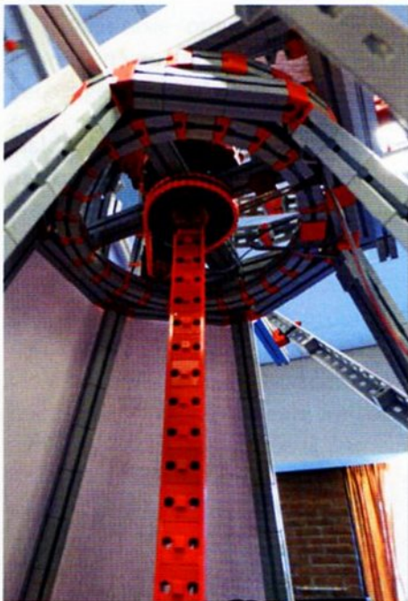
Figuur 6: Overbrenging vanaf de wieken
