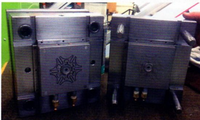
De zeer unieke spuitgietmal voor het Maltezer Kruis
