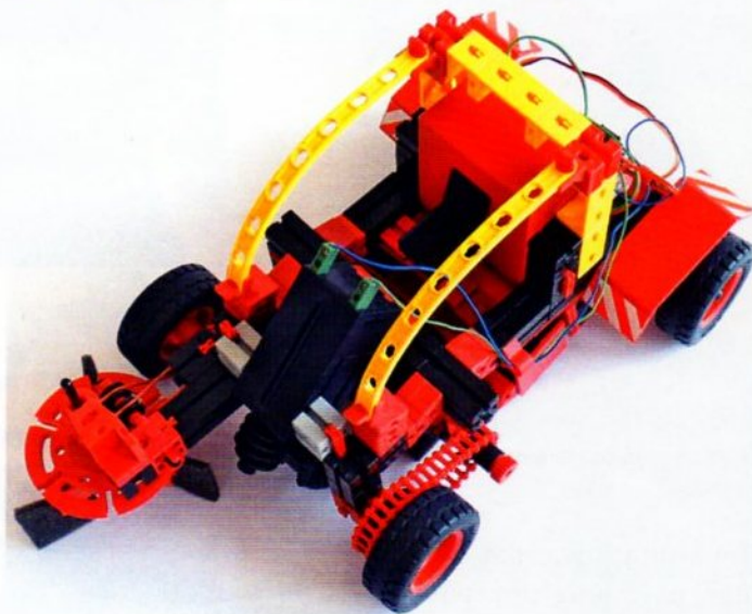
Bovenkant met uitbouw en aandrijving via XM motor
