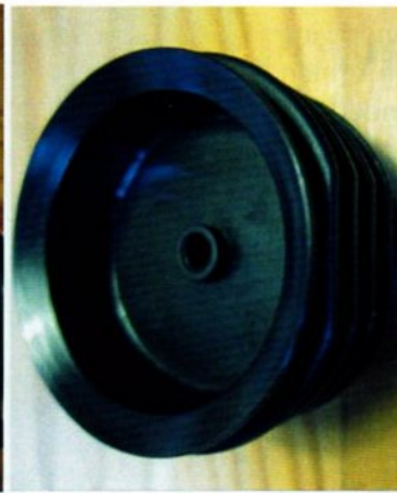
Figuur 9-10: Platte kanten aan de velgen en (rechts) het aflopen van de rupsband.
