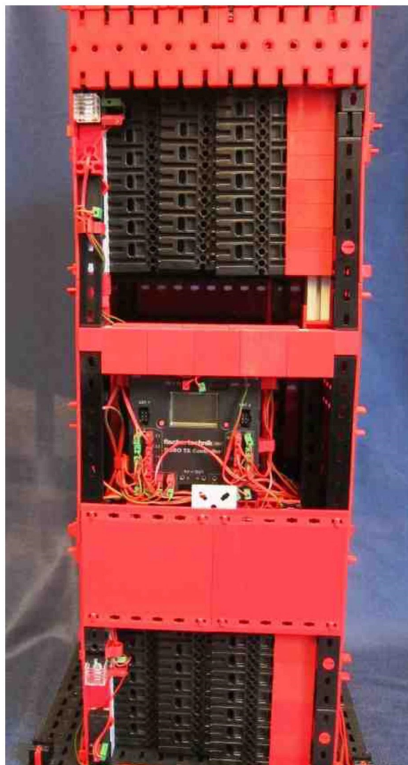
Die Anbauposition des TX-Controllers
