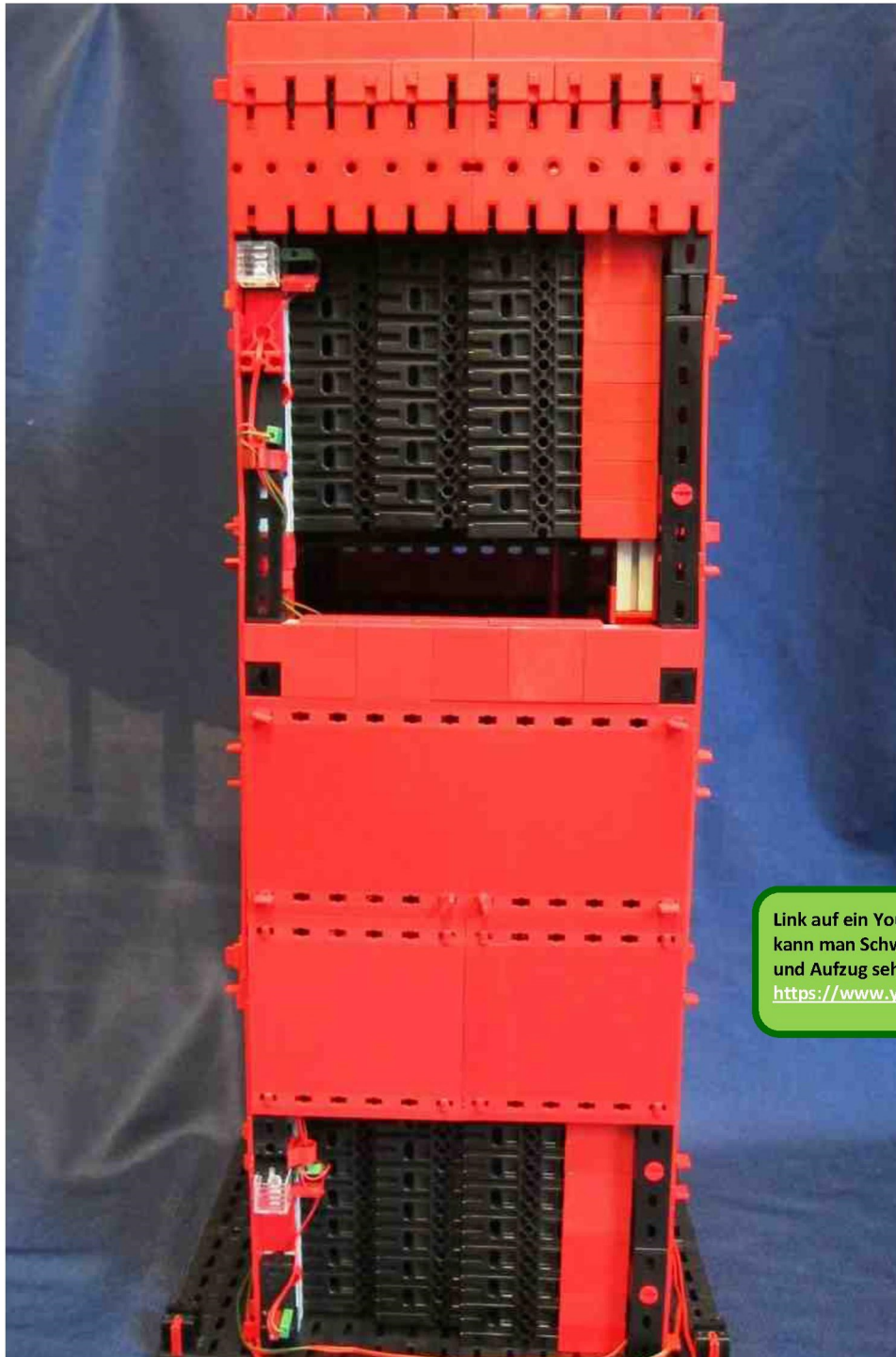
Ein Foto von der Außenseite des Aufzugs. Gut sichtbar sind die zwei Schiebetüren, von denen jede aus Grundplatten 120 x 60 (35129) besteht.
