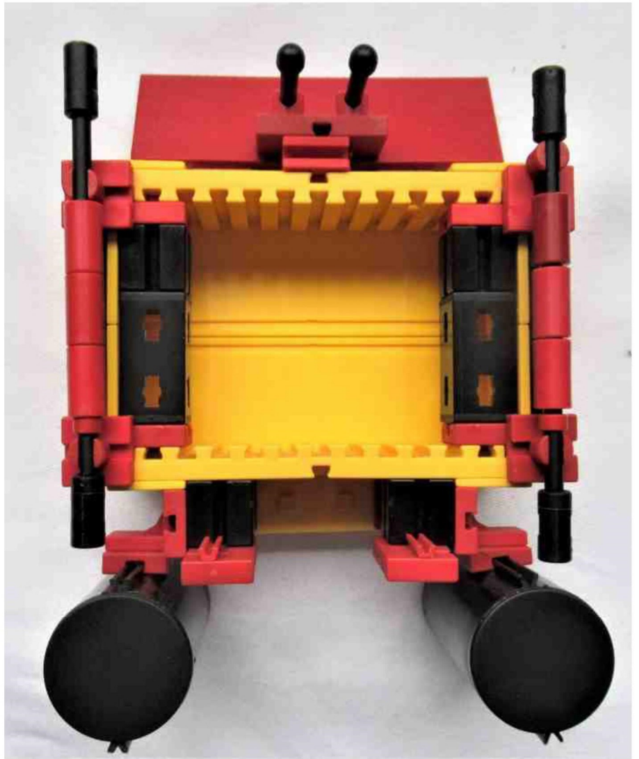
Dan nog de cabine, het zijaanzicht zien we linksboven: tank 30x60 (36702), as snelkoppeling 90 (35066), snelkoppeling (35073), huls 15 (31983), afstandsring 4 mm (31597).
