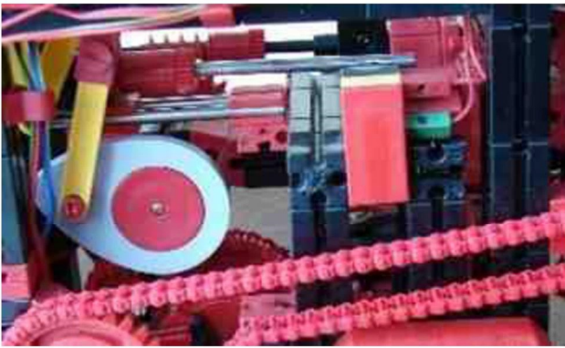
Fig.26: Detectie "Magazijn leeg"
