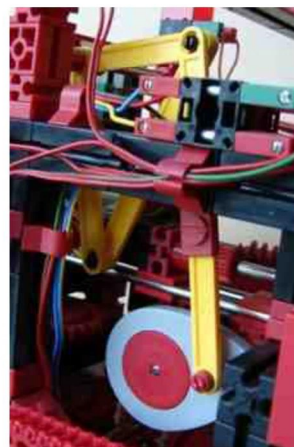
Fig.10: De spantendriehoek, ietwat verstopt in het wagentje; links- boven is het scharnierpunt
