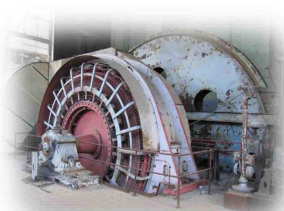
Boven: schema van het Koepesysteem en rechts: ophaalmachine in het ophaalgebouw van de Steenkolenmijn te Waterschei (Be)
