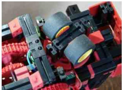
Fig.23: onderzijde met stuurwielen, eindschakelaars en spoorvolger
