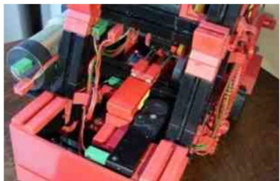
Fig.24: Stuurmotor en pulsgever (de gele fototransistor)
