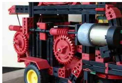
Fig.20: Hoofdmotor met twee wormen op een as
