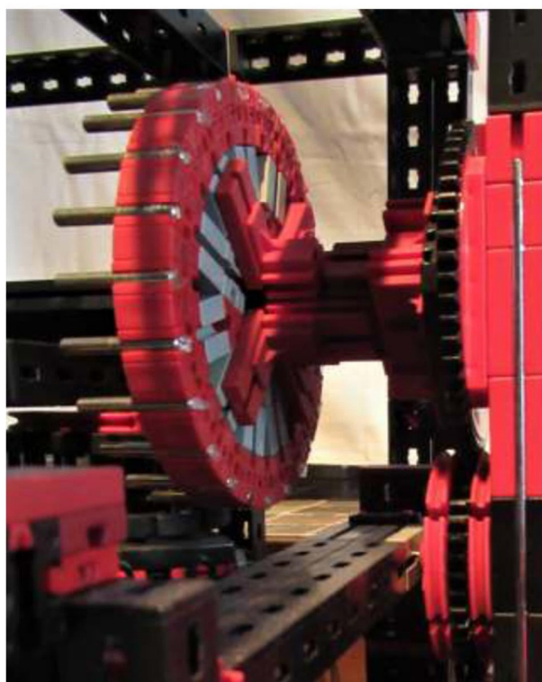
Foto 9a - Spaakwiel, belangrijkste onderdelen, hoeksteen 15° (31981), hoeksteen 60° (31010), bouwsteen 15 (32881), bouwsteen 7.5 (37468), bouwplaat 30x15 1 nok (35049), hoeksteen 10 (38423), draaischijf (31019), metaalas 30mm. (31034)
