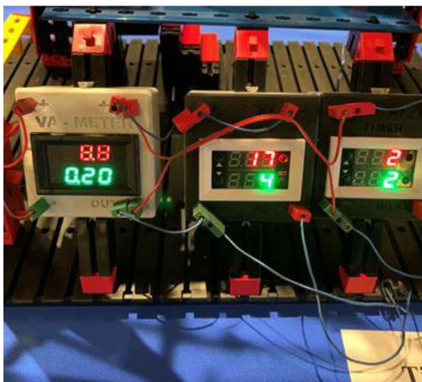
VA-meter en twee timers, de eerste 21 seconde aan, 4 uit, de tweede 2 seconden aan/uit, beide in herhalingsstand
