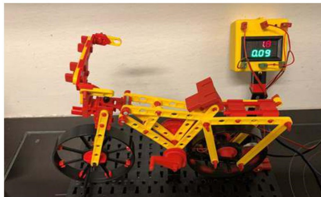
Foto links: LCD meter met een enkele decimaal in stroommeting tijdens het laden van een 8,4 V NiMH ft accu. Foto rechts: Laagspanningsmeter meet spanning (1,8 V) over en stroom (90 mA) door een zonnemotor die een fiets aandrijft.
