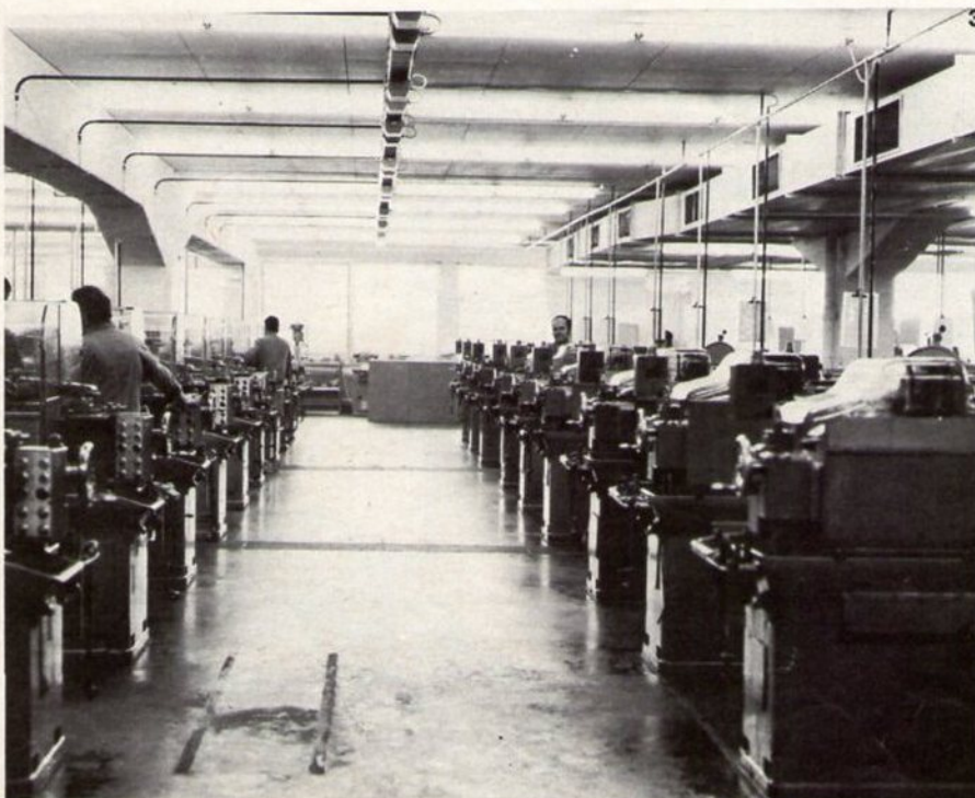
1 Eine Stanze muß immer mit zwei Händen gleichzeitig bedient werden, damit ein Unfall möglichst vermieden wird. Das Foto zeigt die Herstellung von Winkelachsen.
