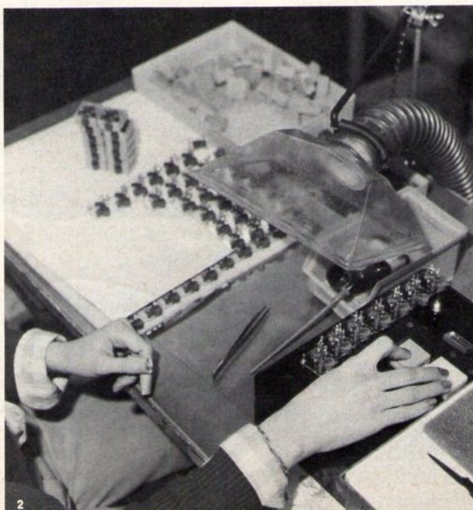
2 De gemonteerde drukknop wordt getest op z'n goede werking
