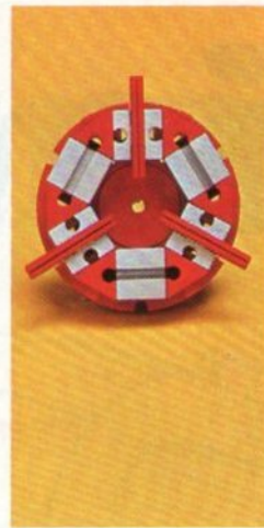
Baustufe 9 zeigt das Dreibackenfutter, das auf der Achse 110, die als Hauptwelle dient, angebracht wird.
