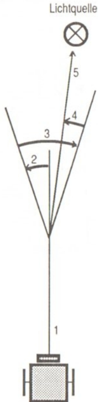
Bild 10.17: Richtungskorrektur bei der Annäherung auf die Lichtquelle.
