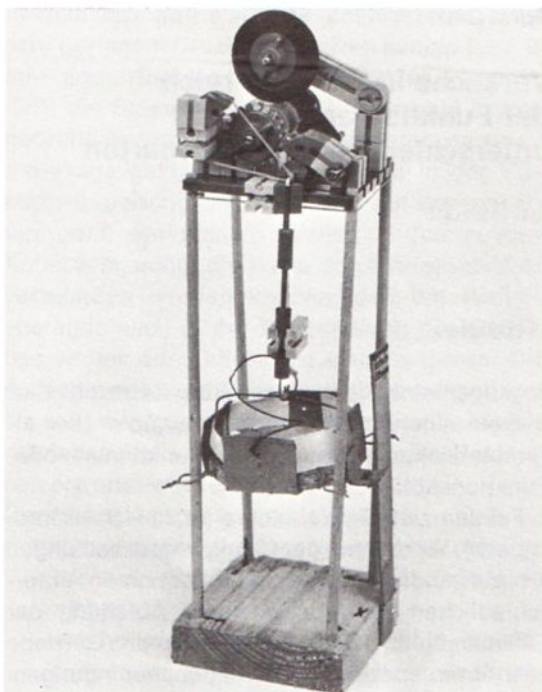
Abb. 7 Lösen der Sperre durch Korbboden; das Gestänge wird durch Gummizug verkantet, damit es in jeder Lage hält
