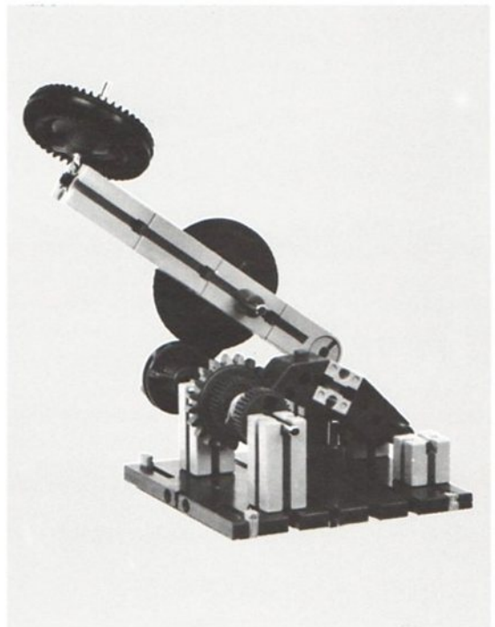
Abb. 8 Die sich selbsttätig regulierenden Bremsen entstanden in der darauffolgenden Unterrichtseinheit
