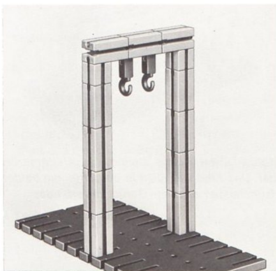
Abb. 1 Bild eines richtig gebauten Schaukelgerüsts. Der Querträger ist belastbar.
