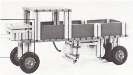
Abb. 5 Korrigierte und erweiterte Lösung: Der Spritzengriff bremst nun das Rad auf einer größeren Fläche ab.
