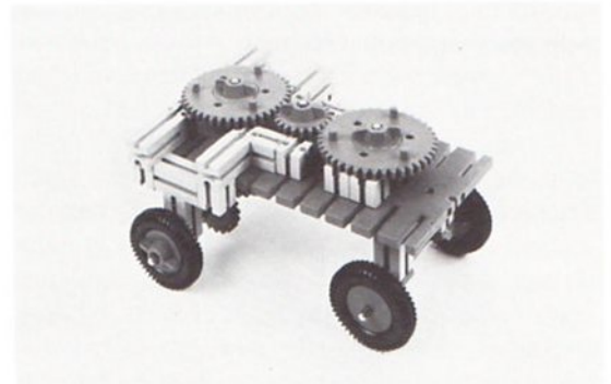
Abb. 8 Modell eines Drehpuppenwagens. Der Antrieb erfolgt durch die Hinterachse über Zahnräder (vgl. Abb. 5a und Abb. 11).
