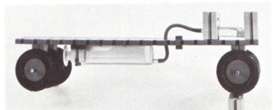
Abb. 4 Erste Lösung: Hinten wird das mittlere Rad gebremst; die Bremsfläche ist klein, da nur die Kante des Spritzengriffs das Rad berührt.
