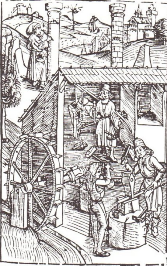
Abb. 9 Wasserrad und Daumenwelle zum Antrieb eines Schwanzhammers, Holzschnitt aus Spechtshart 1488
