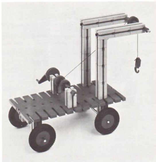
Abb. 4 Beim Messen der Tragfähigkeit zeigte sich, daß auch dieses Modell nur sehr gering belastet werden kann, da der Schwerpunkt in der Nähe der vorderen Kippkante liegt.
