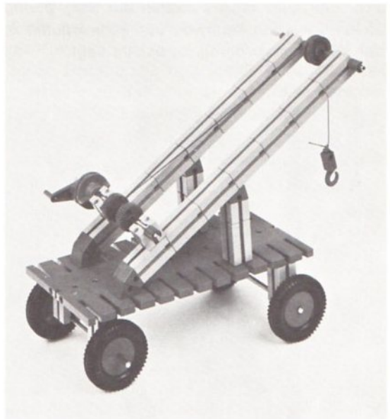
Abb. 3 Modell eines fahrbaren Krans mit einer geringen Tragkraft. Da der Ausleger sehr lang ist, kippt der Kran schon bei einer geringen Belastung um.
