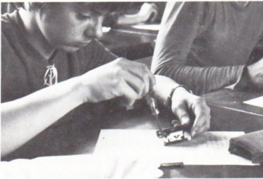
Abb. 18 Das Chubb-schloß wird demontiert
