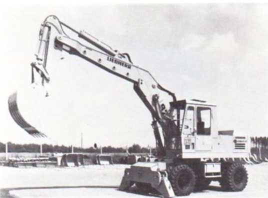
Abb. 10 Bagger. Die verschiedenen Arbeitszylinder und die zu ihnen führenden Schlauchleitungen sind deutlich zu sehen. Man beachte auch die Abstützung zur Vergrößerung der Standfestigkeit.
