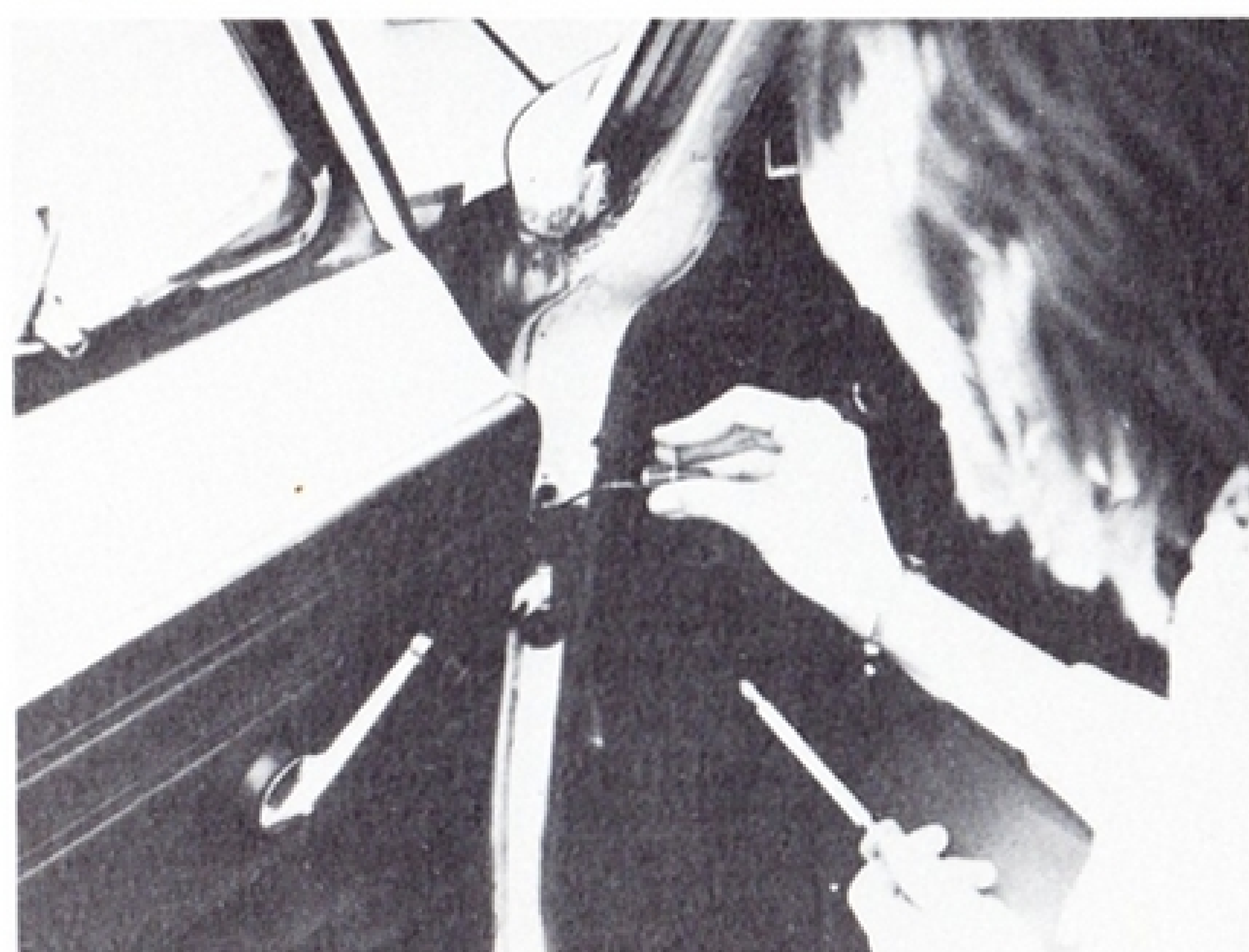
Abb. 14: Der Taster an der linken Tür des Pkw ist ausgebaut.
