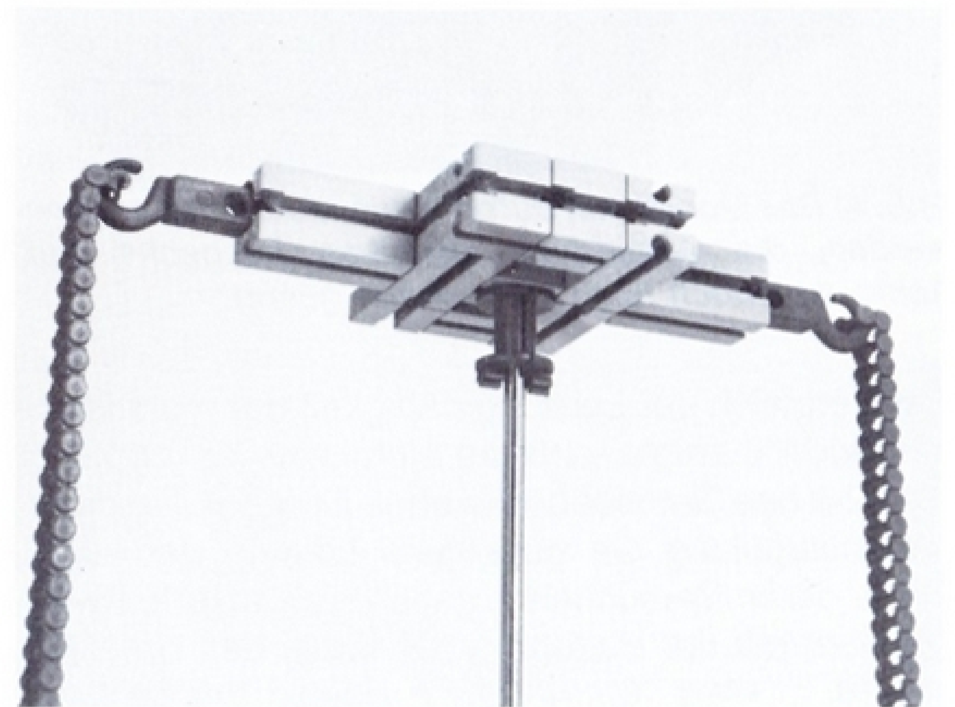
Abb. 2: Der „Drehkörper“ von unten gesehen; die Seiltrommel stellt eine stabile Verbindung zwischen Achse und Drehkörper her.
