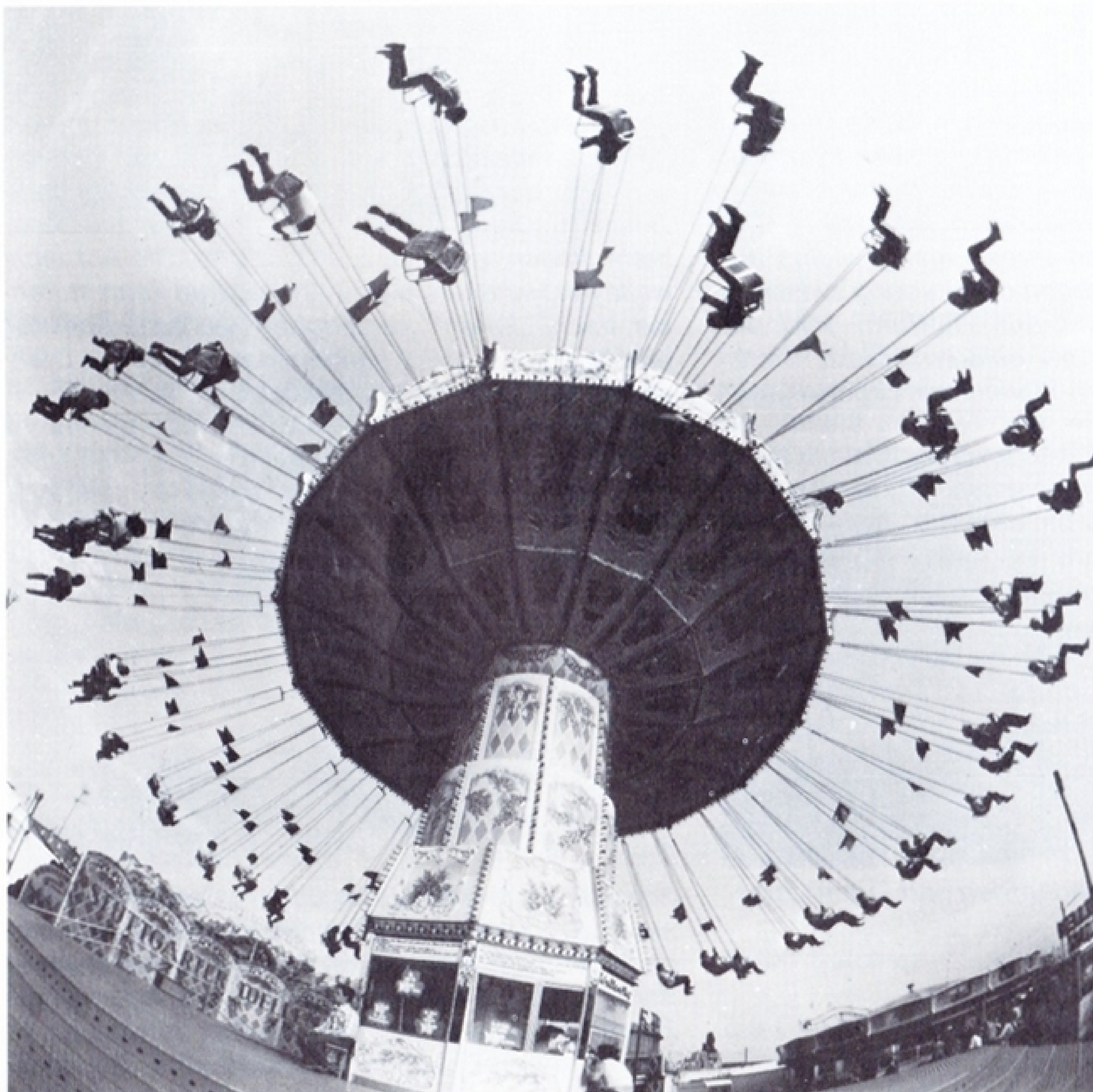
Bedingt durch die Drehgeschwindigkeit und die dabei auftretende Fliehkraft werden Sitze und Personen weit nach außen bewegt.
