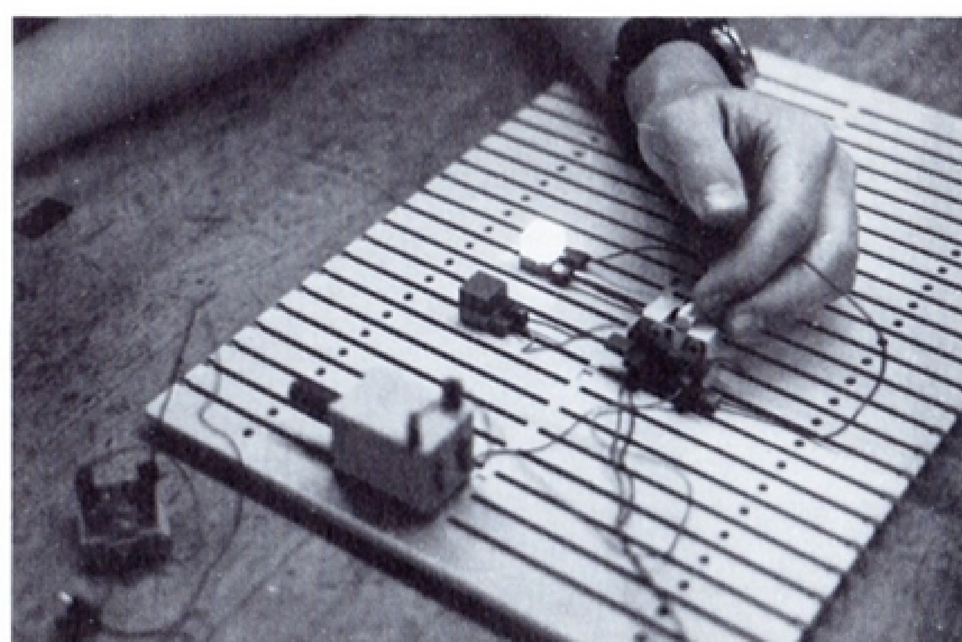
Abb. 16: Probierphase: Einbau des Stellschalters als Polwendeschalter in den Stromkreis; optische Kontrolle über zwei Lampen
