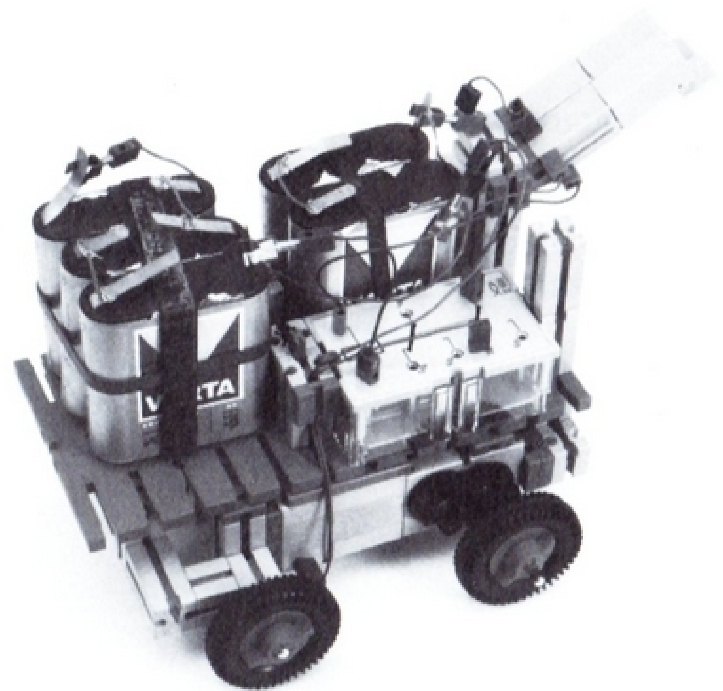
Abb. 23: Fototaktisch negativ reagierendes Modell mit zwei Antriebsmotoren
