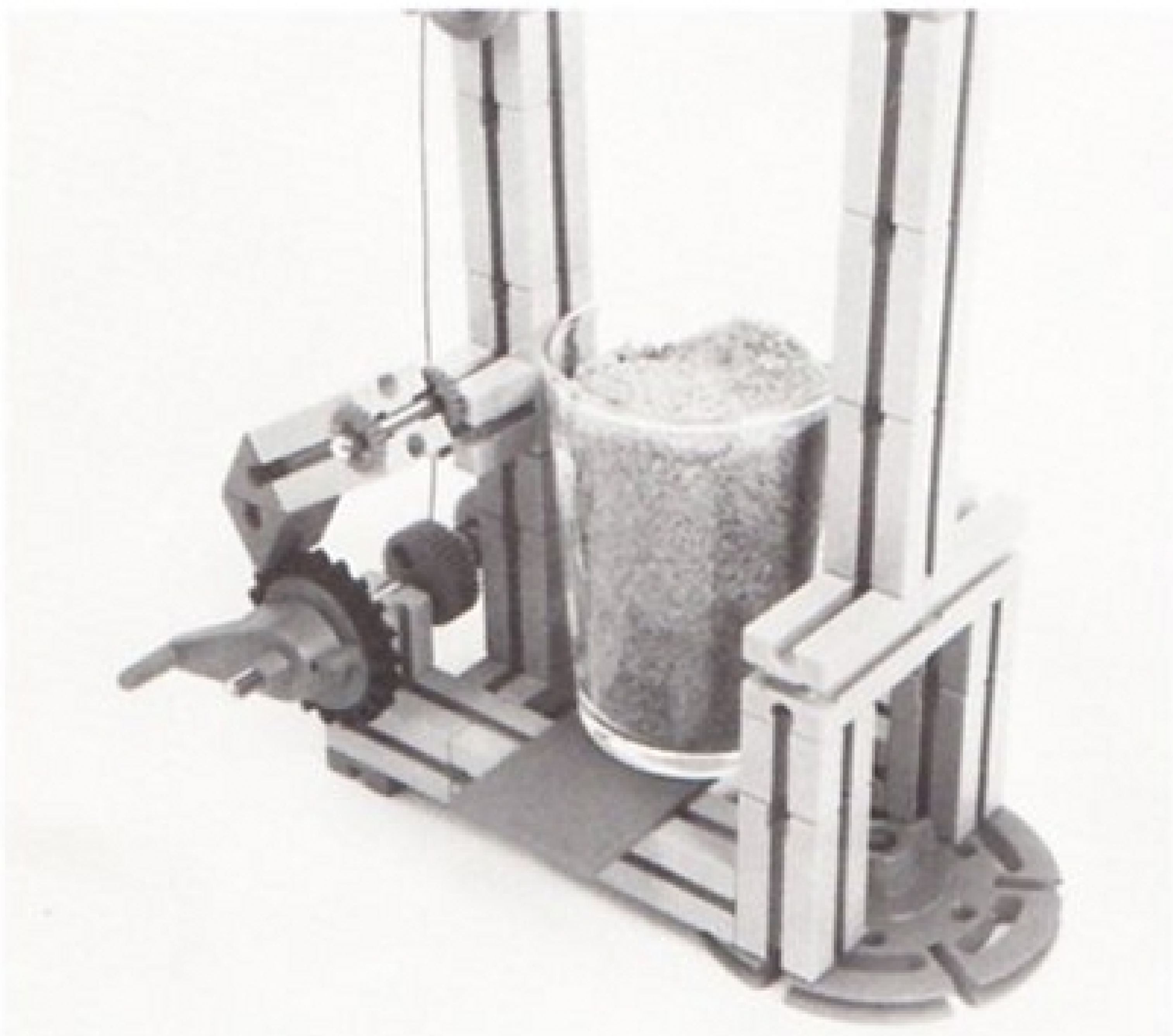
Abb. 8: Aufbau des Krans ähnlich wie in Abb. 6; kleine Behälter mit Ballast (hier Glas mit Sand) dienen als Gegengewicht
