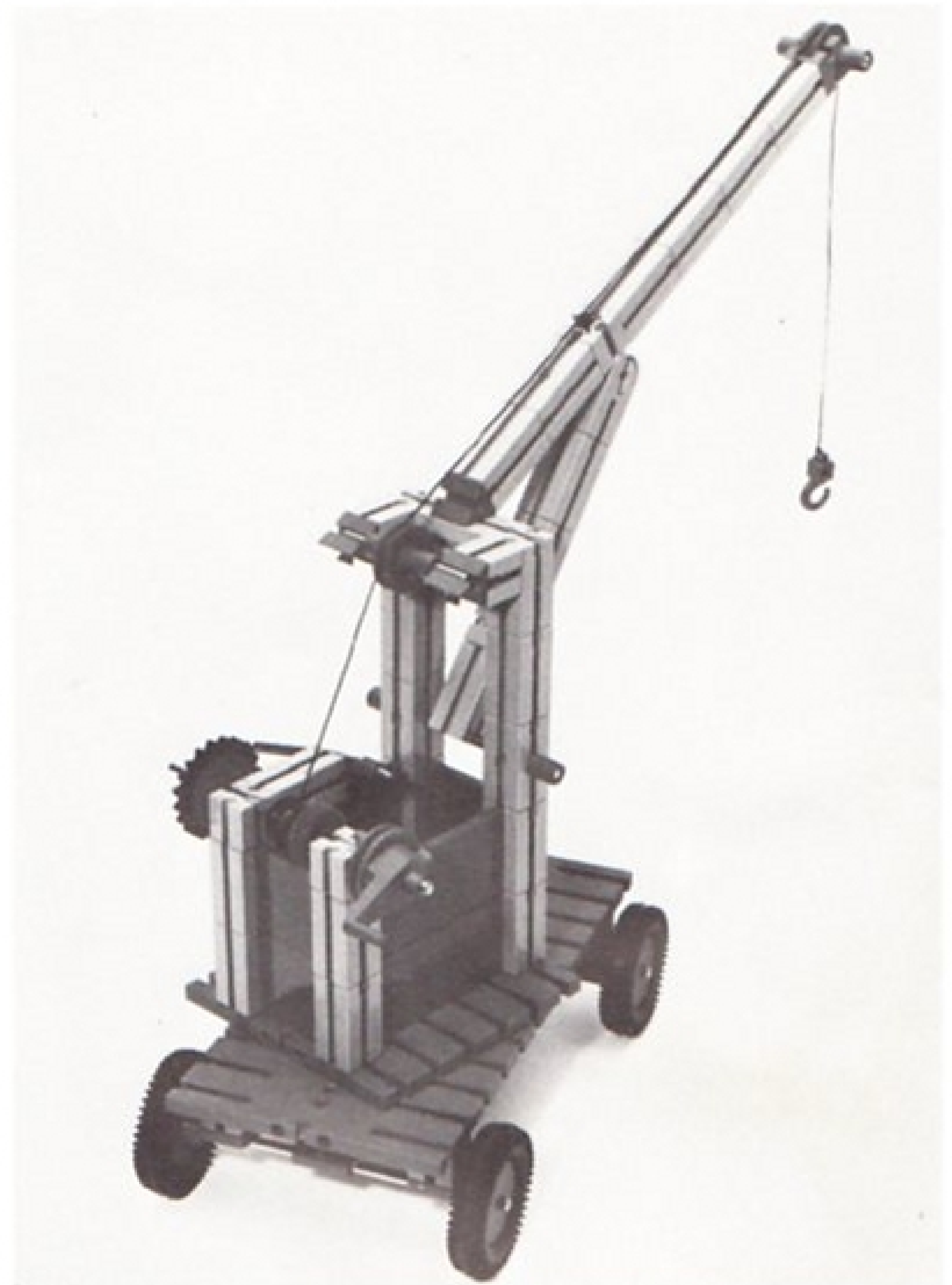
Ab. 7: Kran mit schräggestelltem, starrem Ausleger; stabile Ausführung mit Ballastkasten. Steinchen, Sand oder Wägestücke können hier als Gegengewicht eingefüllt werden. Das Hubwerk kann mit Sperrrad und Sperrklinke (einer Winkelachse) gesperrt werden.
