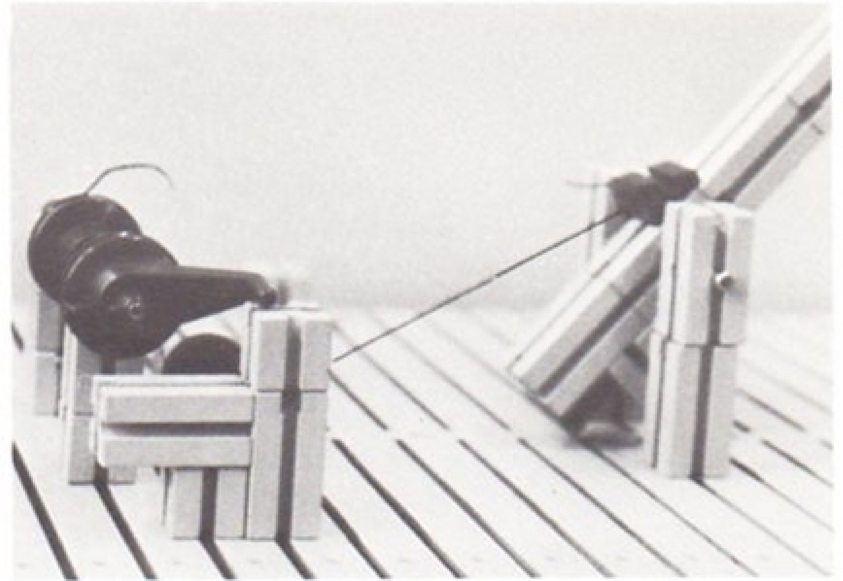
Abb. 4: Das Gesperre hält die Kurbel.
