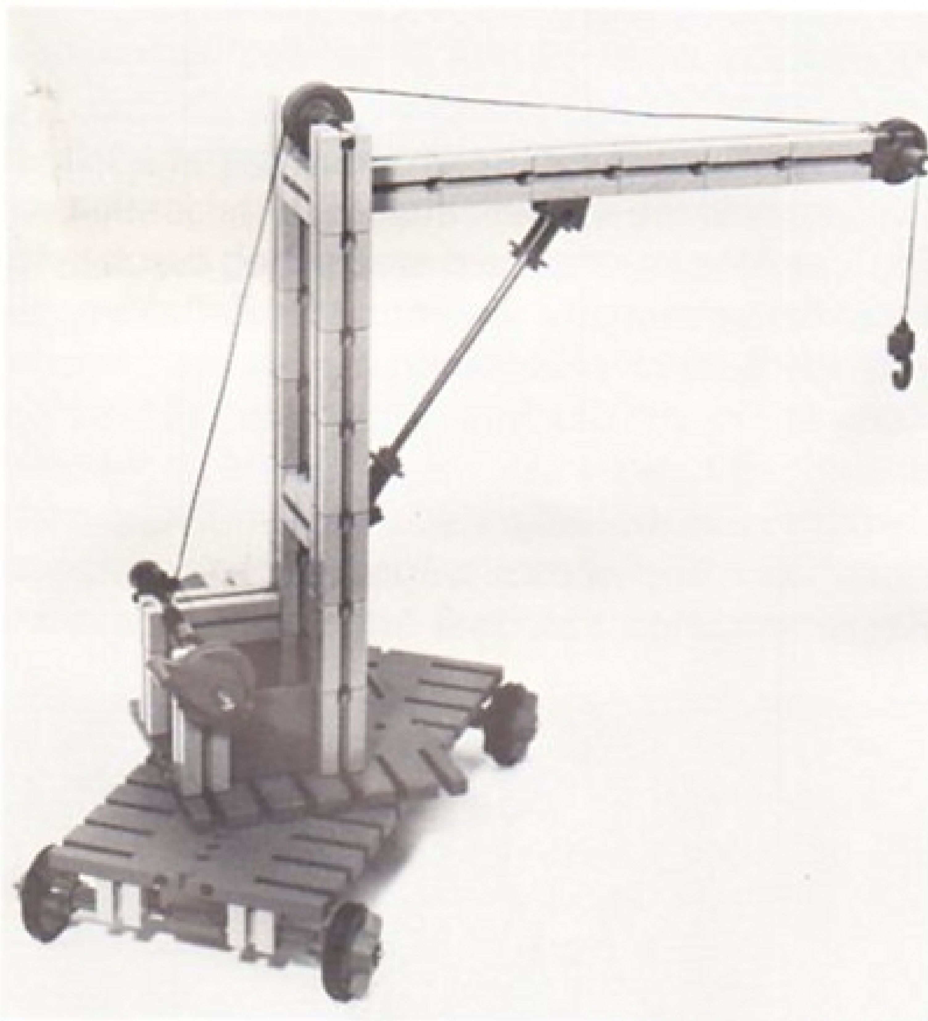
Abb. 3: Einfache Ausführung eines fahrbaren Krans mit drehbarem Turm; die Auslegerrolle ist im Gegensatz zur Rolle in Abb. 2 mit Hilfe des Rollenlagers in der Mittellinie des Auslegers gelagert.
