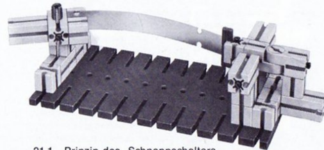
21.1 Prinzip des Schnappschalters
