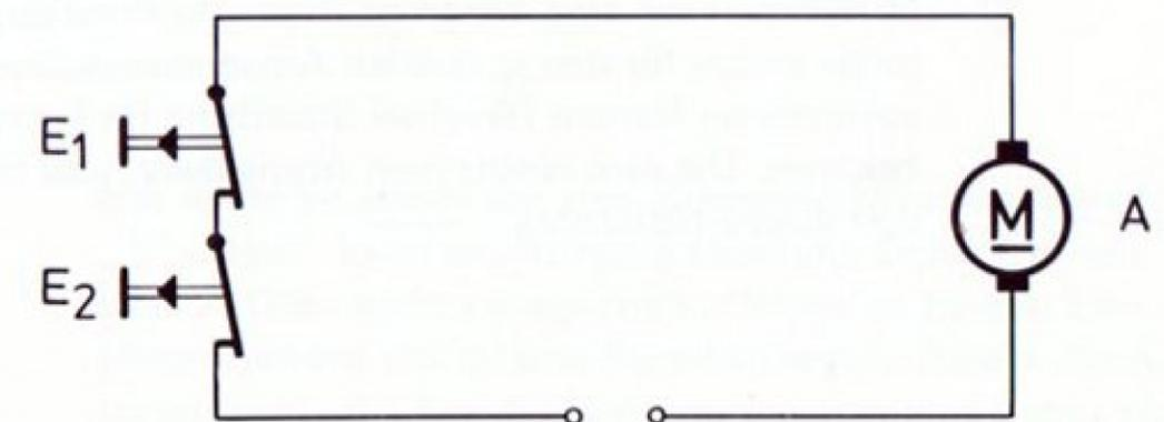
Der Motor bleibt bei beiden Schaltungen stehen, sobald an einem der beiden Ausgänge das Signal „1“ (= Taster gedrückt) anliegt.
