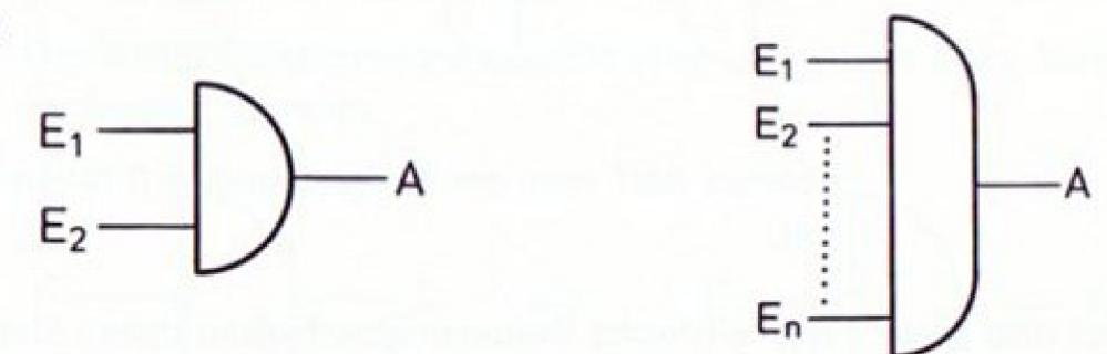
Beim Verknüpfungssymbol für eine „Und“-Schaltfunktion sind die einzelnen Eingänge parallel bis an die senkrechte Begrenzungslinie des Verknüpfungsglieders herangeführt. Je nach der Anzahl der Eingänge zeichnet man die Form dieses Symbols mehr oder weniger hoch.
