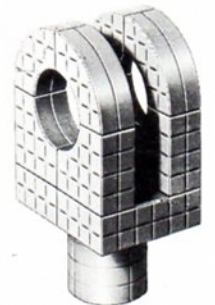
Modellbeispiel fischergeometric 1 + 3: Gabelkopf für Gelenkverbindung
