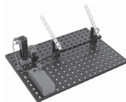
Gleichlaufender Wischer übliche Bauform bei Pkw
